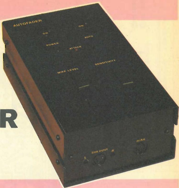
**T**utti i componenti del circuito descritto nella seconda parte di questo articolo sono contenuti in un elegante mobiletto metallico, di discreto aspetto estetico. Il mobile è composto da una struttura interna a cui sono fissati i pannelli anteriore e posteriore e due elementi piegati ad "U" che realizzano i pannelli superiore ed inferiore. Il mobile è in alluminio sagomato, delle dimensioni approssimative di cm 215x125x70.
