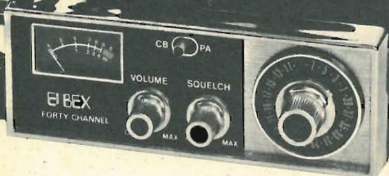
Il "CB402" è un ricetrasmittitore operante sulla banda cittadina (CB) in AM - 27 MHz. Utilizza un circuito sintetizzatore di frequenza in PLL per generare con precisione la frequenza dei 40 canali. Funziona sia su mezzi veicolari, sia in stazione fissa con alimentatore esterno a 13,8 Vc.c. stabilizzati.
